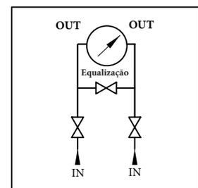
**5.M3A - BSM/M3A - conexão ao processo macho**
